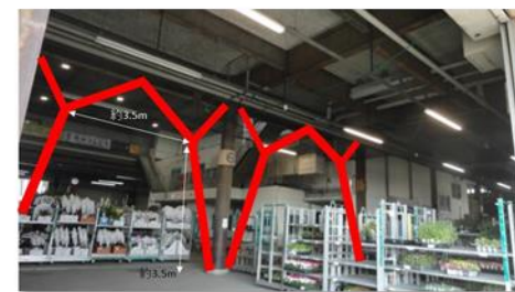
変形筋交いを設置したイメージ
